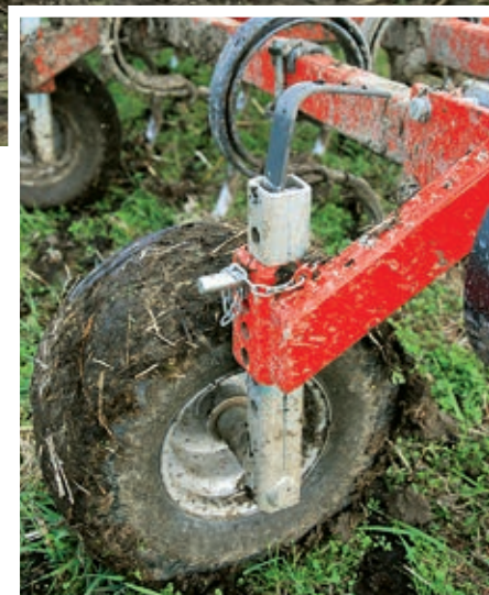
Tiefenverstellung per Stützrad: Der Hebel ist hier noch eine Eigenbaulösung.
