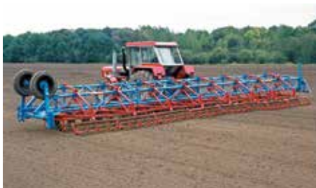
1975: GAROMAT mit Doppelkrümlern und 12 m Arbeitsbreite – damals die breiteste Saatbettkombination Europas!
